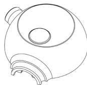
Ohišje sesalne cevi brez priključka
