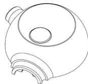
Κάλυμμα ακροφυσίου χωρίς σύνδεση
