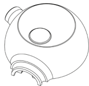
Гнездо на дюзата без съединение
